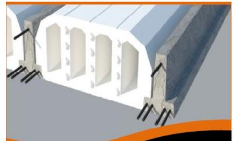
**Recomendaciones para el buen uso y colocación de la Bovedilla:** es conveniente dejar transcurrir 7 días después de descimbrar la losa para poder colocar recubrimientos debajo de la misma (yeso, tirol, etc.) para evitar el movimiento de las piezas en el colado se recomienda sujetarlas con pequeños tramos de alambre recocido.
