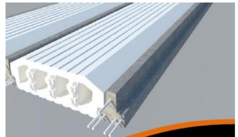
**Recomendaciones para el buen uso y colocación de la Bovedilla:** es conveniente dejar transcurrir 7 días después de descimbrar la losa para poder colocar recubrimientos debajo de la misma (yeso, tirol, etc.) para evitar el movimiento de las piezas en el colado se recomienda sujetarlas con pequeños tramos de alambre recocido.
